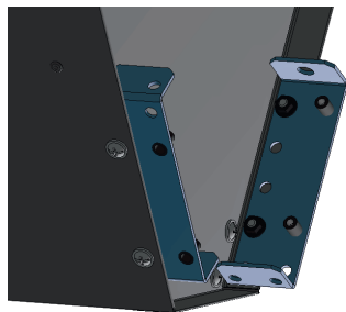
Монтаж крепежа GUARD PRO внутри завесы
